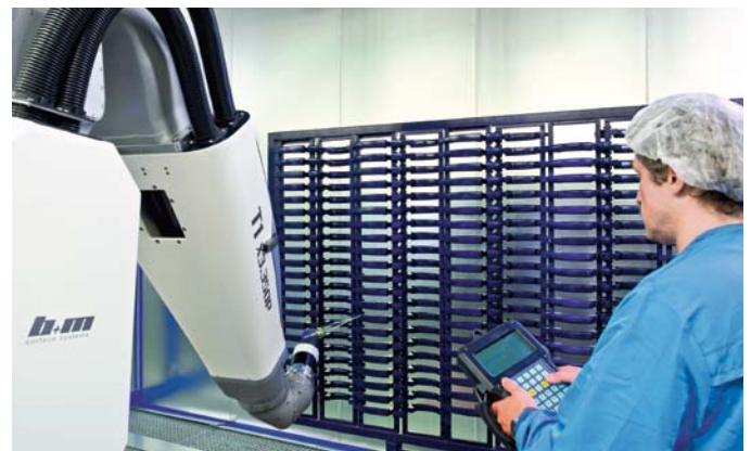
In der Prototypen-/Musterlackieranlage können die Lackierprogramme „vorgeteacht“ und unter Produktionsbedingungen optimiert werden.
