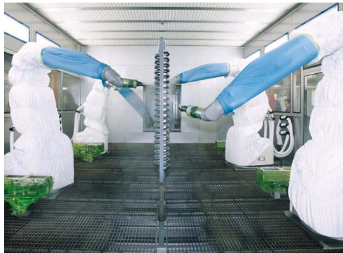
Vier Roboter übernehmen als Lackiereinheit den Beschichtungsprozess und lackieren die auf Skids zugeführten Kunststoffteile.
