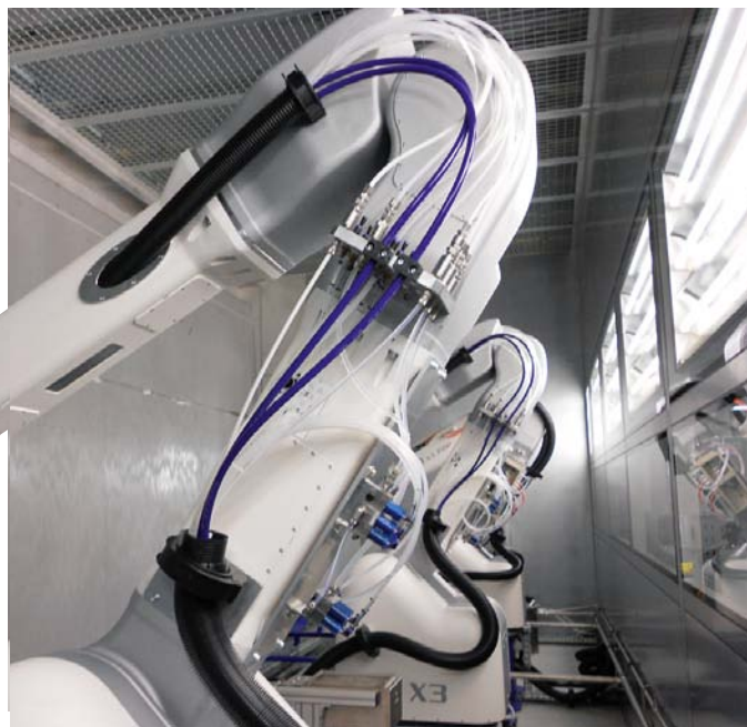
Roboter mit montierten Molchstrecken zum Molchen zwischen Zerstäuber und Farbwechsler
