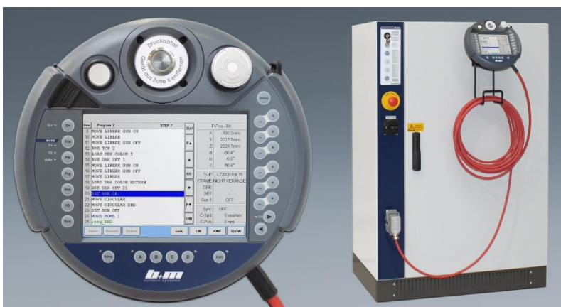
Die mit dem T1 X5 eingeführte Steuerung wurde inklusive Software für die Lackierroboter der T2-Serie übernommen.
