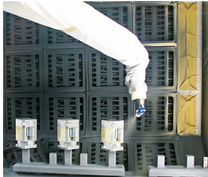
In der Roboterlackierkabine sind Trockenfilter zur Lacknebelabscheidung integriert.
