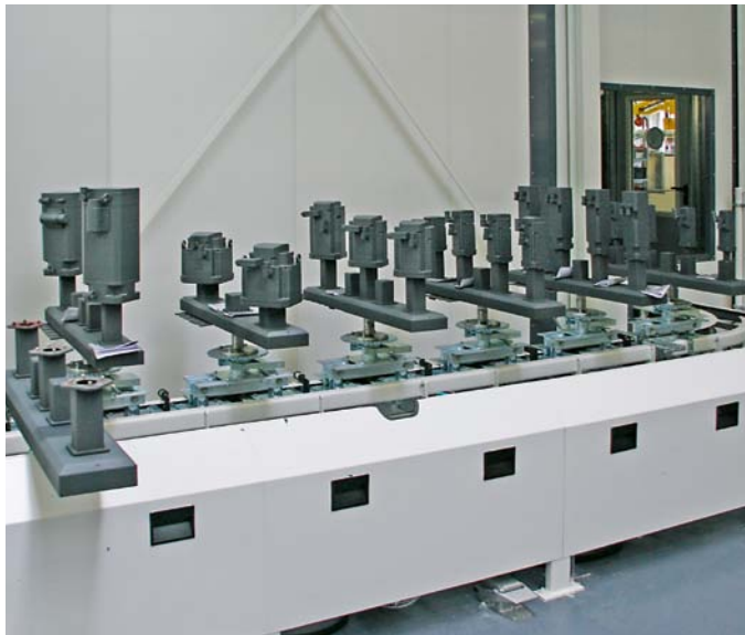
Der Teiletransport wird über P+F-Bodenfördertechnik realisiert.
