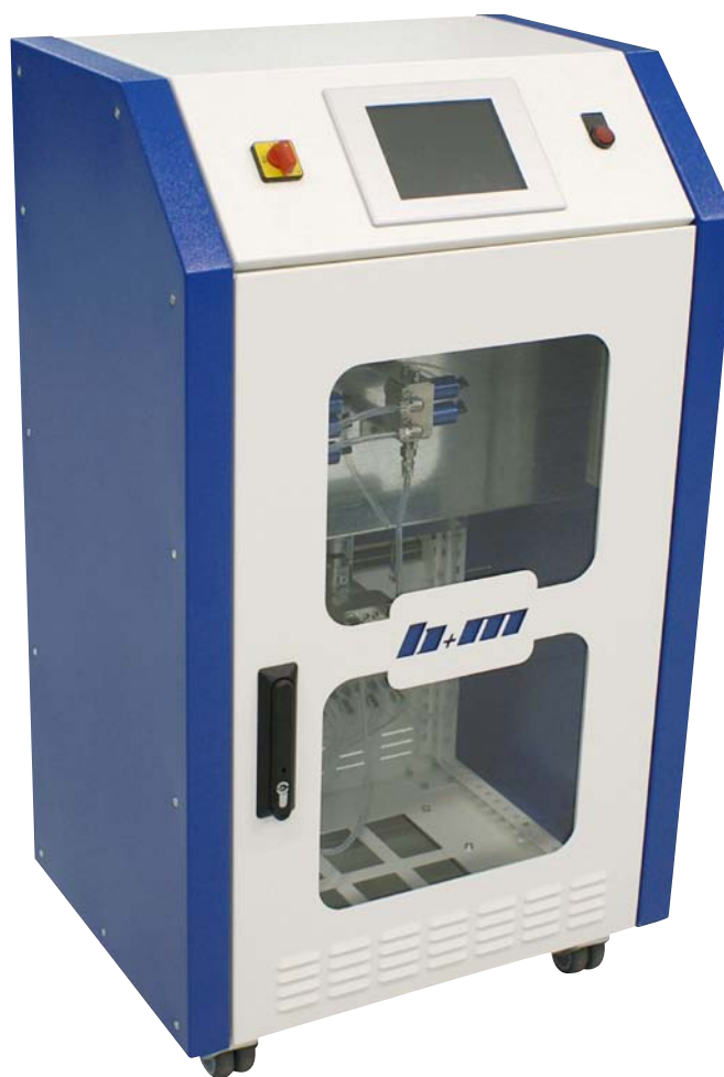
Das Bild zeigt das neu vorgestellte Anlagenkonzept. Mit der Anlage können Anwender Materialien mit unterschiedlichsten Verarbeitungseigenschaften kontinuierlich mischen und dosieren.
