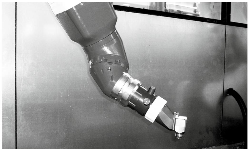
A/B-Farbwechsellmolchsysteme, hier ist ein Molchadapter auf einem Roboterarm zu sehen, ermöglichen Farbwechsel in nur 6 sec. Das System kommt in dem Bereich vom Dosiersystem zum Applikator zum Einsatz und senkt den Lackverbrauch um ca. 90%.
