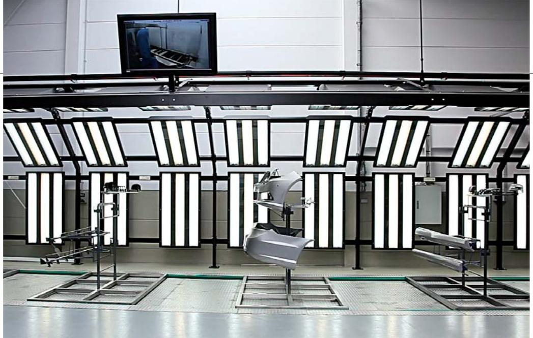
Die Aufgabe und Abnahme der Werkstücke erfolgen in einem Lichttunnel, der dem Auditstandard der Automobilindustrie entspricht. Quelle: Weiss automotive
