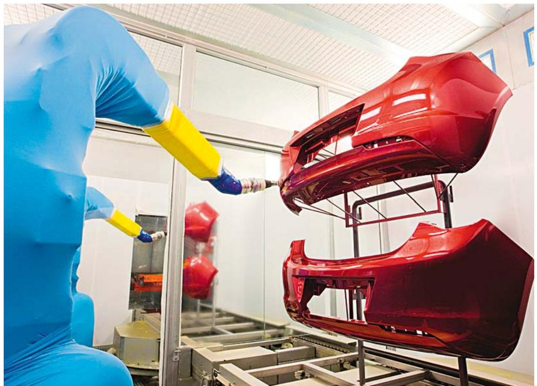
Die Lackierkabinen bei Weiss automotive sind mit sechsachsigen Lackierrobotern und Drehtischen für die Warenträger ausgestattet. Quelle: Weiss automotive
