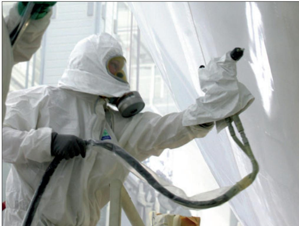
**Bei der Lackierung eines A380 verarbeiten die Lackierer fast eine Tonne Lackmaterial. Über die in der Fertigungshalle installierten Teleplattformen erreichen sie von oben jede Ecke des Flugzeugs.**
