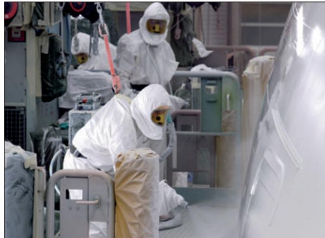
**Die Lackierer arbeiten in bis zu 25 m Höhe, über Teleplattformen erreichen sie von oben jede Ecke des Flugzeugs.** Quelle: Airbus
