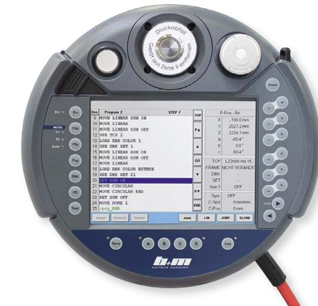
Das Bediengerät ist als Mobile Panel mit Farbgrafikanzeige und Touch-Bedienung ausgeführt.
